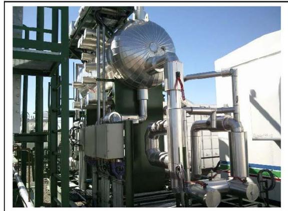
**Test Run Separadores Trifásicos y Bifásicos:** Verificación, configuración y calibración de los Instrumentos de Medición ya montados en el Separador, como así también la verificación y corrección de todas las comunicaciones ModBus (promedio de 25 Instrumentos por Separador); Puesta a Punto del Equipo y Ejecución de 6 Ensayos mínimo por Separador con contraste contra Tanque Calibrado.
